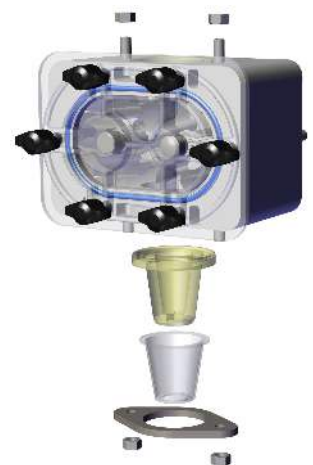
Fig. 17 : Buse conique avec couvercle
