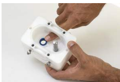
Fig. 14: Insérer les deux bagues d'étanchéité d'arbre graissées
