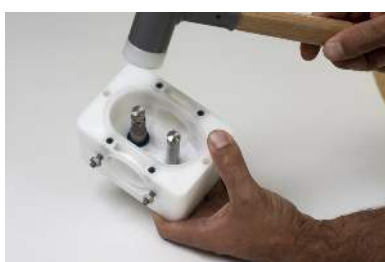
Fig. 12: Faire sortir l'arbre d'entraînement hors du boîtier
