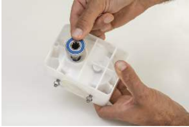
Fig. 15: Insérer l'arbre d'entraînement
