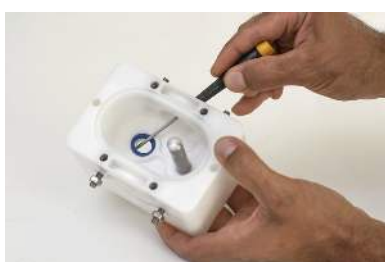
Fig. 13: Retirer les deux bagues d'étanchéité d'arbre
