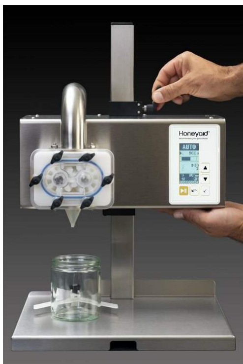
Fig. 5: Réglage de la hauteur
