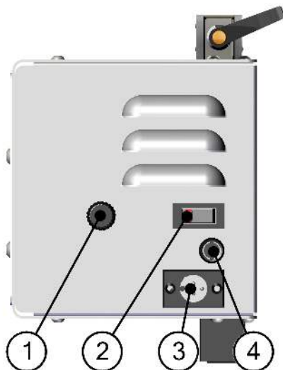
Fig. 2 : Côté droit du module d'entraînement
